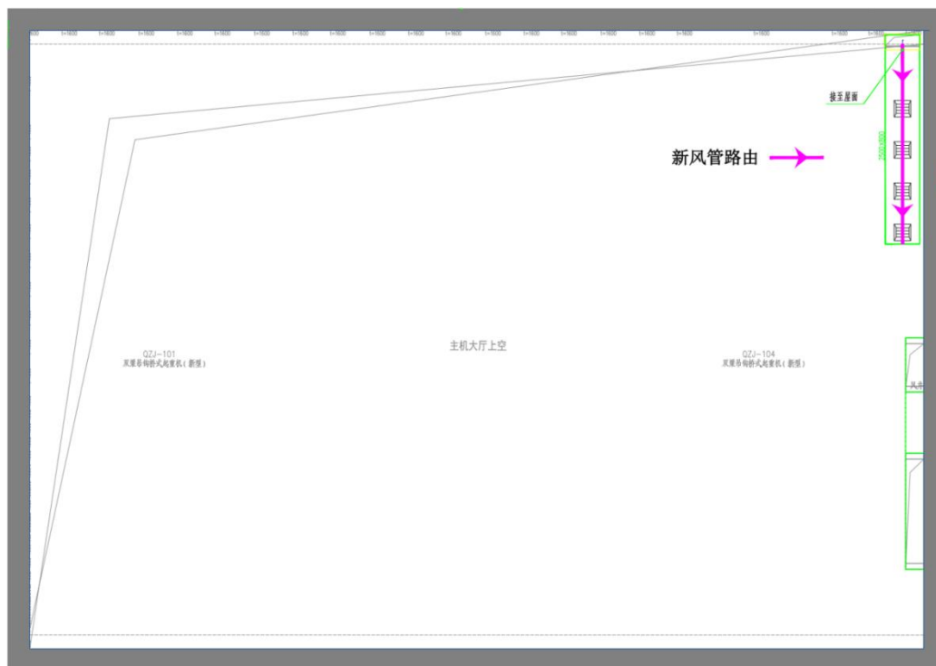
a) 主机车间一层 27 米处新风管路由
